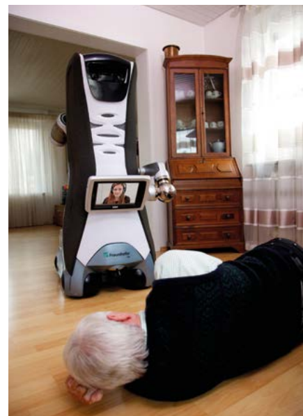
Das Service-Center des Care-O-bot nutzt den Roboter zur Kommunikation mit dem gestürzten Benutzer.
